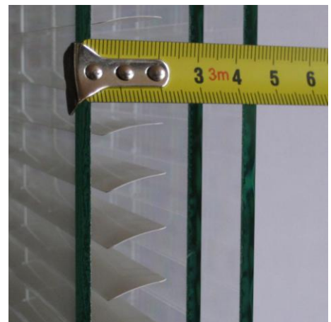
Nordicon trelags termorude med indbygget persienne og Air/Krypton gas. Warmex kanter. 45 mm rudetykkelse
